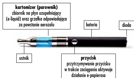
Rycina 1. Schemat budowy e-papierosa
